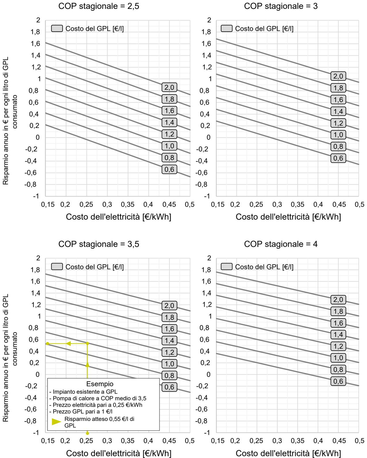
Dati riferiti ad un impianto esistente alimentato da una caldaia standard a GPL con rendimento medio stagionale del 90%.
