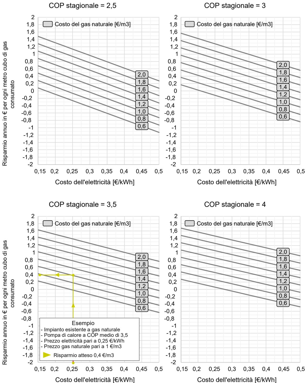
Dati riferiti ad un impianto esistente alimentato da una caldaia standard a gas naturale con un rendimento medio stagionale del 90%.
