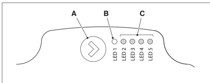
L'interfaccia utente permette di visualizzare le prestazioni in funzionamento (stato funzionamento e stato allarme) e impostare le modalità di funzionamento del circolatore.
