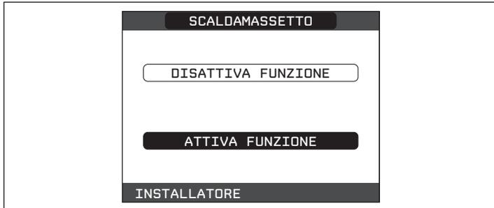
La funzione scaldamassetto, quando attiva, viene segnalata nella schermata principale dal messaggio scorrevole a piè di pagina **FUNZIONE SCALDAMASSETTO IN CORSO – TEMPERATURA DI MANDATA**, mentre sulla scheda elettronica lampeggiano in modo alternato i led rosso e verde con frequenza 1sec ON – 1sec OFF.
