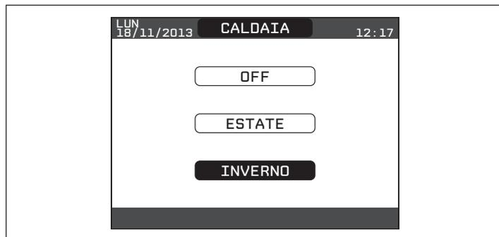
**!** Tutte le volte che la caldaia viene alimentata viene eseguito un ciclo di sfiato automatico della durata di 15 min. Quando il ciclo di sfiato è in corso tutte le richieste di calore sono inibite e un messaggio scorrevole a piè di pagina compare nella schermata principale del REC.
