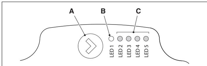
L'interfaccia utente permette di visualizzare le prestazioni in funzionamento (stato funzionamento e stato allarme) e impostare le modalità di funzionamento del circolatore.
