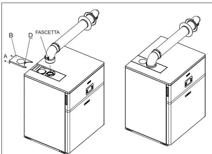
⚠ La lunghezza rettilinea si intende comprensiva della prima curva (connessione in caldaia), di terminali e giunzioni. Viene fatta eccezione per Condotto coassiale Ø 60-100 mm verticale, la cui lunghezza rettilinea non comprende le curve.
