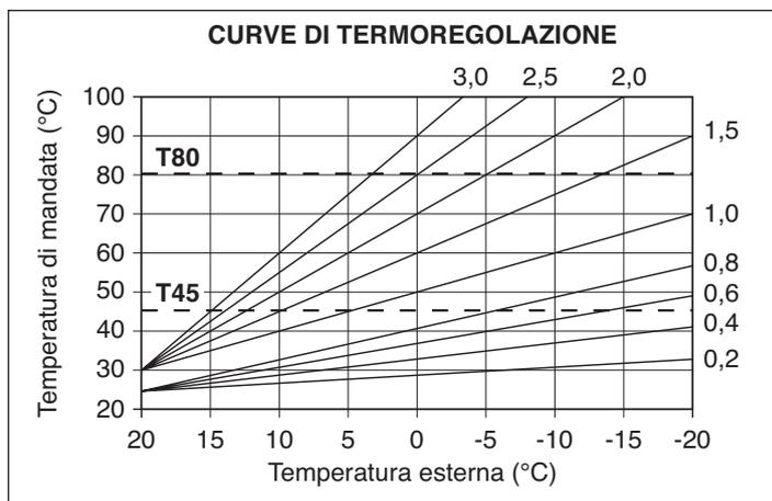
**T80** massima temperatura setpoint riscaldamento impianti standard
