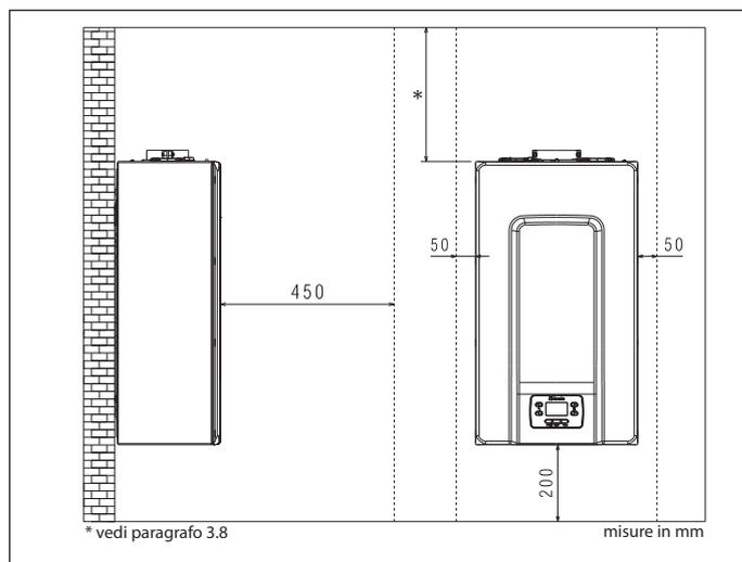
**!** In caso di installazione è **INDISPENSABILE** prevedere gli spazi necessari per l'introduzione dello strumento per l'analisi combustione. Riportiamo un disegno campione dove le distanze tra caldaia e pensile/nicchia sono state ottenute utilizzando uno strumento di lunghezza 300 mm. Strumenti di lunghezze superiori necessitano di spazi maggiori.
