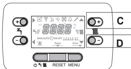
La successiva pressione del tasto **C** oppure **D** consente di impostare il valore del setpoint riscaldamento all'interno del range prestabilito:
