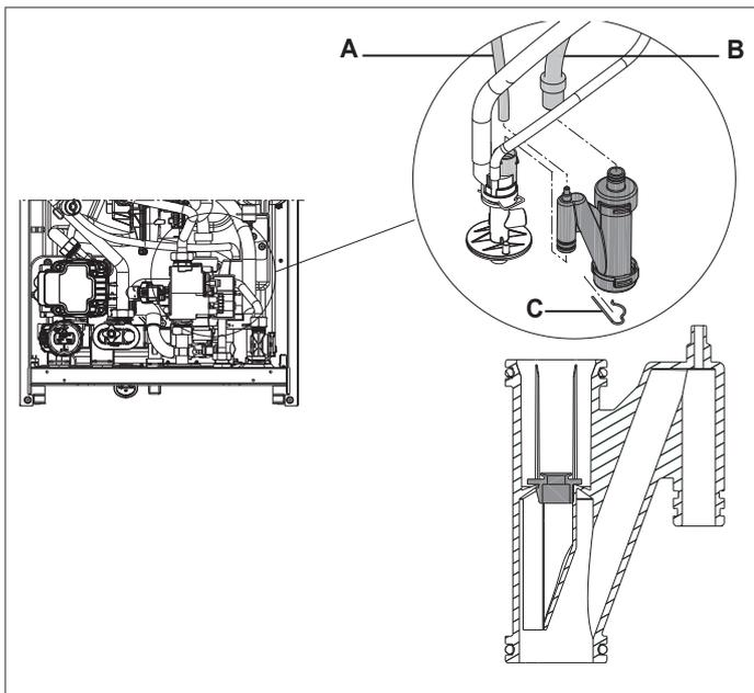
In caso di inutilizzo dell'apparecchio per più di 60 giorni, è necessario provvedere al riempimento del sifone in caldaia. Se la caldaia è installata ove la temperatura ambiente può rimanere per prolungati periodi sopra i 30°C, riempire il sifone dopo un periodo di 30 giorni di inutilizzo. L'operazione deve essere effettuata da personale professionalmente qualificato.
