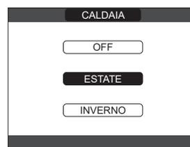
INVERNO / : selezionando nel menù STATO → CALDAIA → INVERNO si attivano le funzioni di riscaldamento e acqua calda sanitaria. Sul REC10EXPH-N viene normalmente visualizzata la temperatura dell'acqua sanitaria a meno che non sia in corso una richiesta di riscaldamento, nel qual caso viene visualizzata la temperatura di mandata della caldaia.
