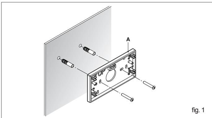
⚠ Per il corretto funzionamento, assicurarsi che la superficie di montaggio al muro sia piana.
