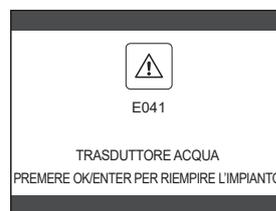
Durante la fase di caricamento sul display compare il messaggio scorrevole a piè di pagina "RIEMPIMENTO SEMIAUTOMATICO IN CORSO", il valore di pressione evidenziato sul display dovrebbe iniziare a salire. Alla fine del caricamento il messaggio scorrevole "TERMINATO RIEMPIMENTO SEMIAUTOMATICO" viene visualizzato a piè di pagina.
