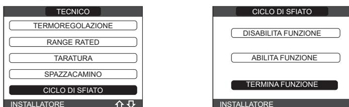
Il REC10EXPH-N visualizzerà per un attimo un messaggio di attesa dopo di che si riporterà automaticamente sulla schermata principale. Il ciclo di sfiato può essere anche interrotto, se caldaia non in OFF, da una richiesta di calore sanitario.
