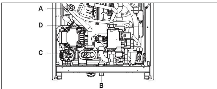
NOTA: anche se la caldaia è provvista di un dispositivo di riempimento semiautomatico, la prima operazione di riempimento dell'impianto deve essere fatta agendo sul rubinetto di riempimento (B) con caldaia in stato OFF.
