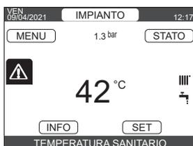
Muoversi all'interno del display fino ad evidenziare l'icona ⚠. Il messaggio di errore verrà visualizzato. La schermata di descrizione anomalie si attiva automaticamente una volta trascorso il tempo di illuminazione del display senza che sia stato premuto alcun tasto.
