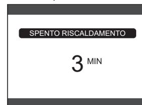
**AZZERAZIONE TEMPI RISC:** questo parametro consente di azzerare la TEMPORIZZAZIONE POTENZA MASSIMO RISCALDAMENTO RIDOTTA, durante la quale la velocità del ventilatore risulta limitata al 75% della massima potenza riscaldamento impostata, e la TEMPO-
