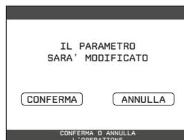
Successivamente viene chiesto di confermare l'impostazione del setpoint: selezionare “**Ok**” oppure “**BACK**” mediante up e down e validare la scelta premendo il tasto “**Ok**”.
