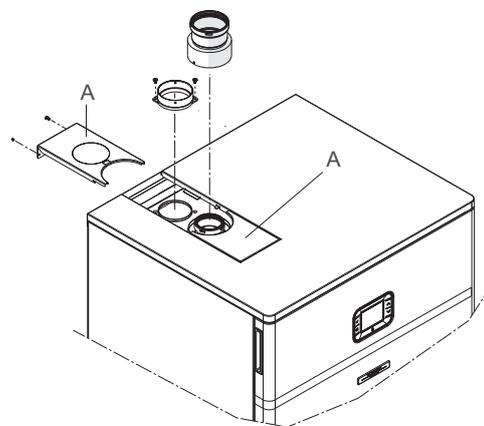
A: per rimuovere le parti svitare le viti di fissaggio
