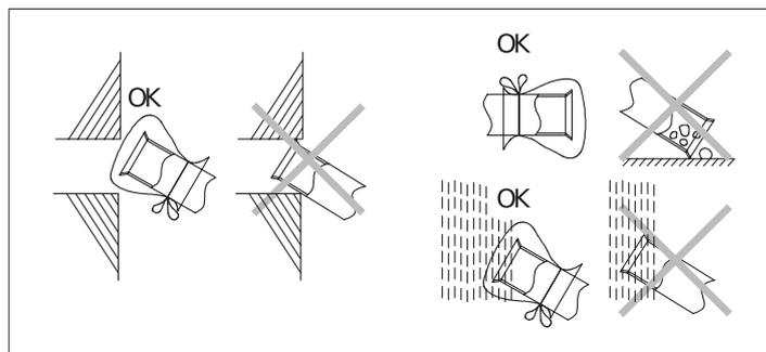
**⚠** Prima di inserire le linee attraverso il foro sul muro tappare le estremità.
