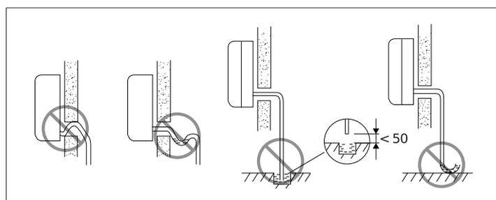
**⚠** Il sistema di scarico deve prevedere un adeguato sifone per prevenire l'indesiderata entrata d'aria nel sistema in depressione. Il sifone inoltre impedisce l'infiltrarsi di odori o insetti.
