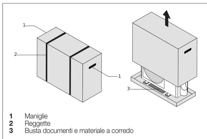
A seguire sono indicate le operazioni di rimozione dell'imballo e movimentazione dell'unità:
