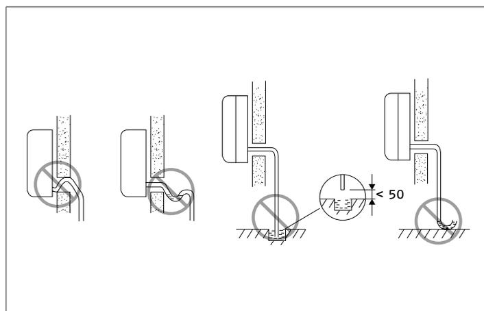
**⚠** Il sistema di scarico deve prevedere un adeguato sifone per prevenire l'indesiderata entrata d'aria nel sistema in depressione. Il sifone inoltre impedisce l'infiltrarsi di odori o insetti.
