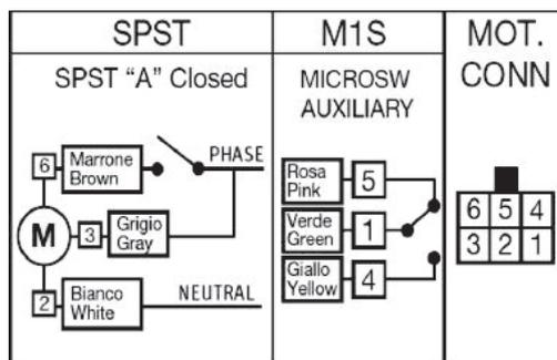
Per il collegamento elettrico fare riferimento alla morsettiera dell'unità interna
