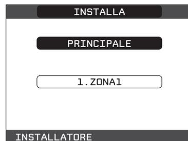
Al termine della richiesta di calore, se CONF IDRAULICA = ZONA MISCELATA, viene attivata in chiusura la valvola miscelatrice per un tempo pari a 2min. Durante questo tempo la pompa resta attiva a meno che non vi siano altre zone in richiesta di calore, in questo caso la pompa viene spenta immediatamente. Eventuali nuove richieste di calore da parte della stessa zona no verranno prese in considerazione prima che siano trascorsi i 2min di chiusura della valvola miscelatrice.
