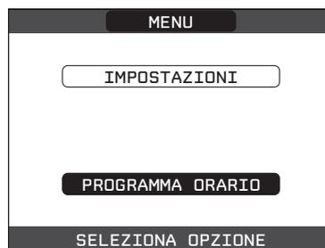
Da questo menù è possibile accedere alla visualizzazione e regolazione della programmazione oraria per le funzioni riscaldamento/raffrescamento di una zona piuttosto che il carico del bollitore sanitario da caldaia piuttosto che da pompa di calore in base allo schema di impianto.
