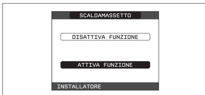
La funzione scaldamassetto, quando attiva, viene segnalata nella schermata principale dal messaggio scorrevole a piè di pagina FUNZIONE SCALDAMASSETTO IN CORSO – TEMPERATURA DI MANDATA, mentre sulla scheda elettronica lampeggiano in modo alternato i led rosso e verde con frequenza 1sec ON – 1sec OFF.
