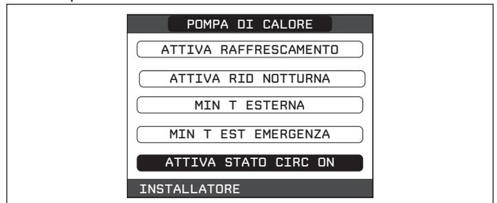
Il circolatore della pompa di calore continuerà a funzionare fino a quando non viene impostato nuovamente lo stato AUTO oppure fino a che la caldaia non viene messa in stato INVERNO o ESTATE. L'attivazione della funzione viene segnalata da un messaggio scorrevole a pie' di pagina nella schermata principale del REC10H
