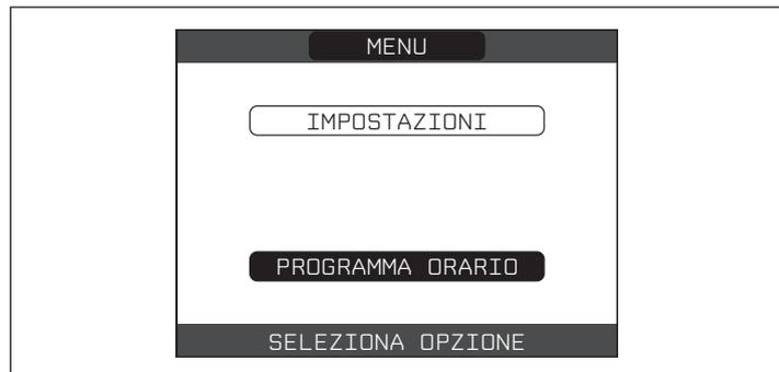
Da questo menù è possibile accedere alla visualizzazione e regolazione della programmazione oraria per le funzioni riscaldamento/raffrescamento di una zona piuttosto che per il carico del bollitore sanitario da caldaia e da pompa di calore (se installata).
