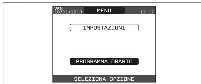
Da questo menù è possibile accedere alla visualizzazione e regolazione della programmazione oraria per le funzioni riscaldamento/raffrescamento di una zona piuttosto che per il carico del bollitore sanitario da caldaia e da pompa di calore (se installata).
