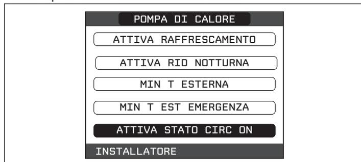
Il circolatore della pompa di calore continuerà a funzionare fino a quando non viene impostato nuovamente lo stato AUTO oppure fino a che la caldaia non viene messa in stato INVERNO o ESTATE.
