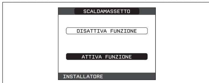
La funzione scaldamassetto, quando attiva, viene segnalata nella schermata principale dal messaggio scorrevole a piè di pagina FUNZIONE SCALDAMASSETTO IN CORSO – TEMPERATURA DI MANDATA, mentre sulla scheda elettronica lampeggiano in modo alternato i led rosso e verde con frequenza 1sec ON – 1sec OFF.
