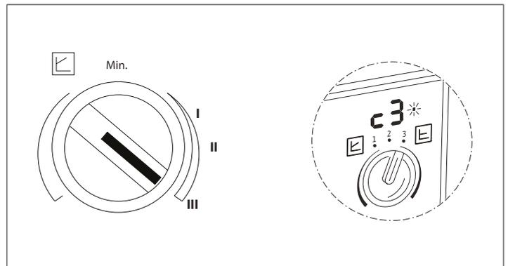
In fase di avviamento dell'impianto si raccomanda di posizionare il selettore della velocità al massimo.
