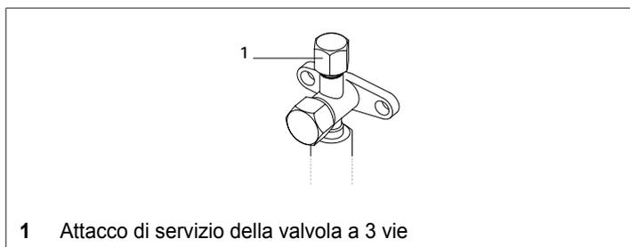
— caricare il circuito con azoto attraverso l'attacco di servizio presente sulla valvola d'intercettazione a 3 vie
