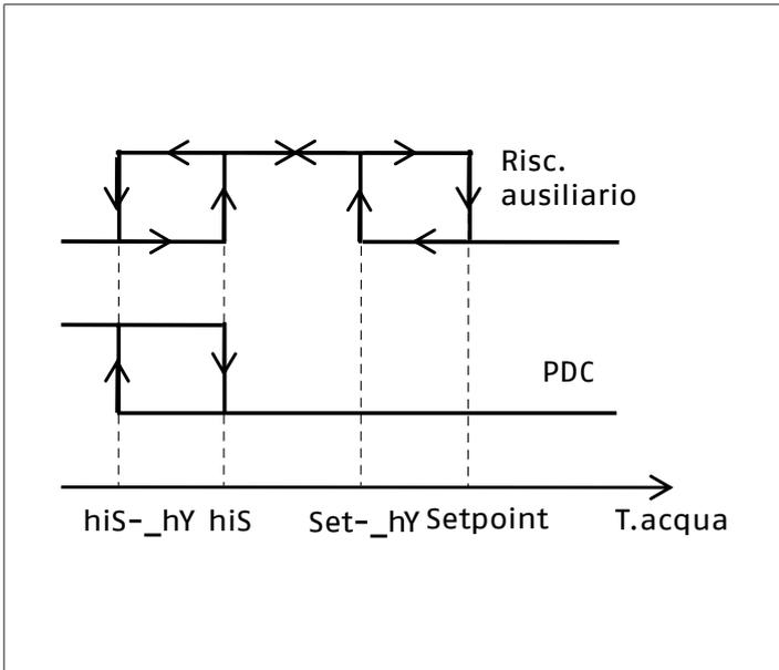
— se viene impostato un setpoint al di sopra dei 50 °C\* il controllore spegne la pompa di calore ed attiva il teleruttore K1.
