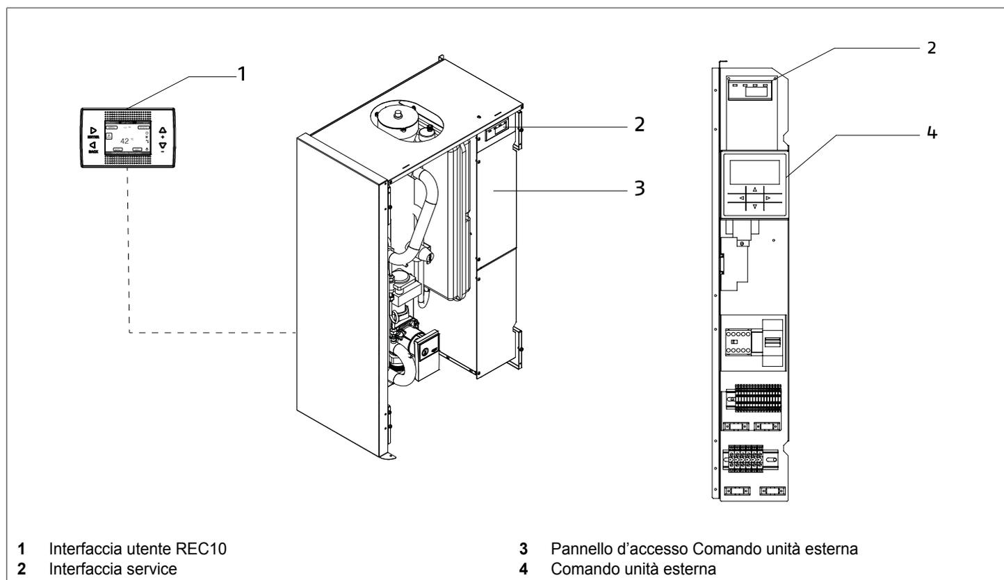
Il sistema è dotato di 3 tipi di interfaccia di comando:
