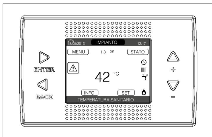
L'interfaccia utente dell'unità, anche denominata interfaccia REC10I, è installata remotamente.
