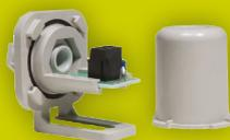
Sonda esterna da installare a nord, consente la gestione delle zone impianto con curva climatica
