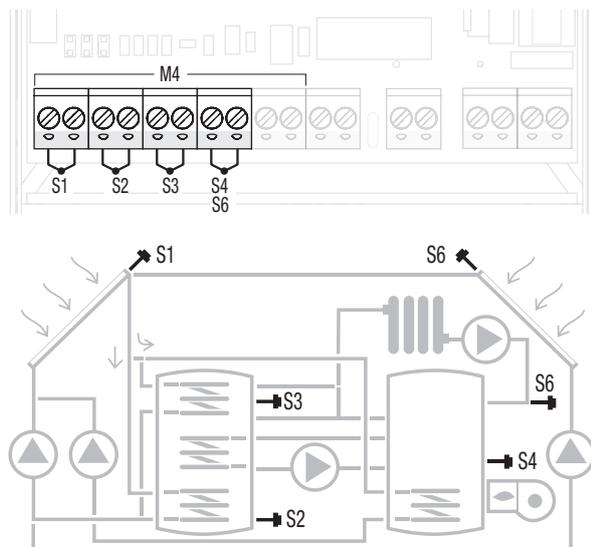
Le sonde di temperatura allacciate possono essere controllate con un multimetro-tester. La corrispondenza tra temperatura e resistenza è indicata nelle tabelle seguenti.
