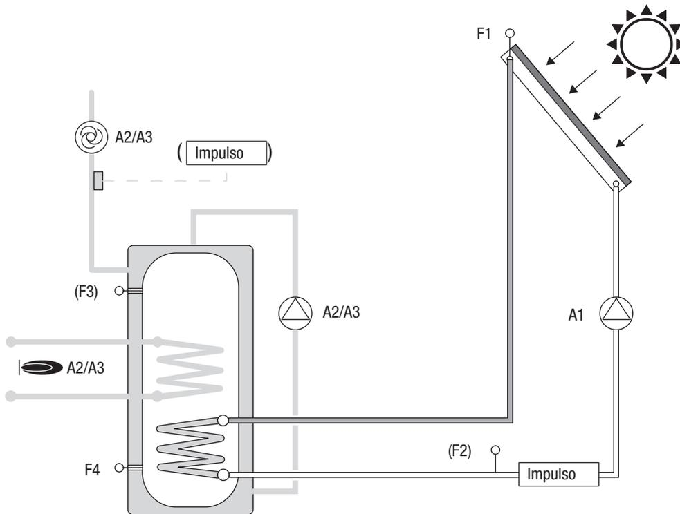
Impianto 4 - Regolazione solare con due collettori
