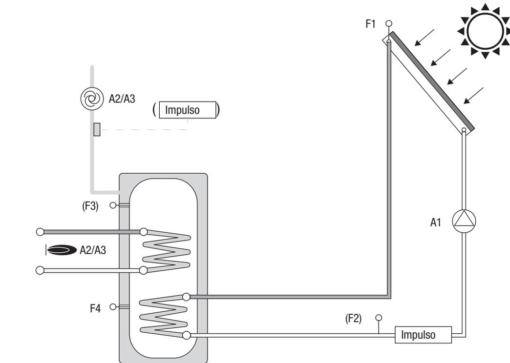
Impianto 7 (variante) - Regolazione solare con funzione di riscaldamento supplementare
