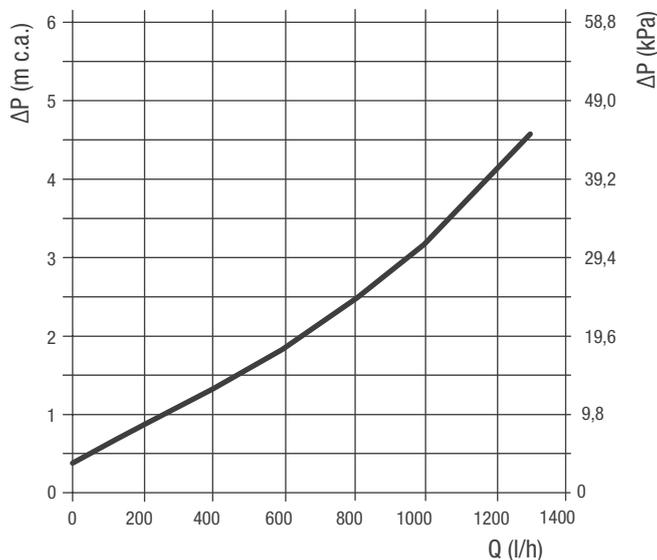
Per ricavare la prevalenza utile, sottrarre il valore di perdita di carico a quello di prevalenza letto nel diagramma del circolatore solare qui di seguito.
