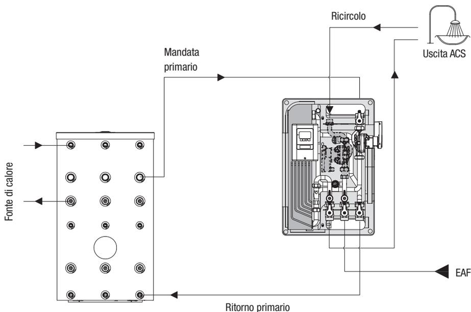
Il modulo deve essere posizionato in prossimità dell'accumulo. Il sistema è dimensionato per una lunghezza delle tubazioni di collegamento tra modulo e bollitore pari a 4 metri (andata + ritorno).
