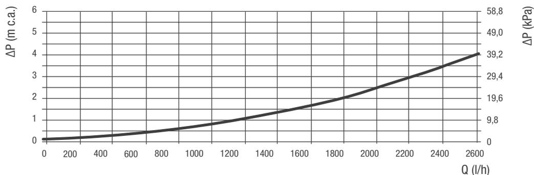
Per ricavare la prevalenza utile, sottrarre il valore di perdita di carico a quello di prevalenza letto nel diagramma del circolatore solare qui di seguito.
