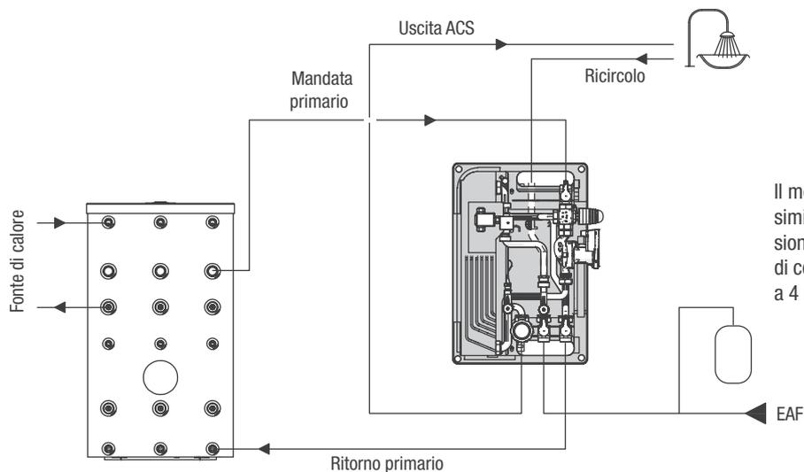
Il modulo deve essere posizionato in prossimità dell'accumulo. Il sistema è dimensionato per una lunghezza delle tubazioni di collegamento tra modulo e bollitore pari a 4 metri (andata + ritorno).
