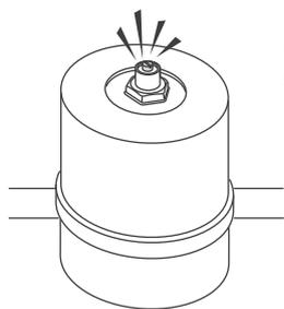
Il circuito solare sia completamente sfiato.
