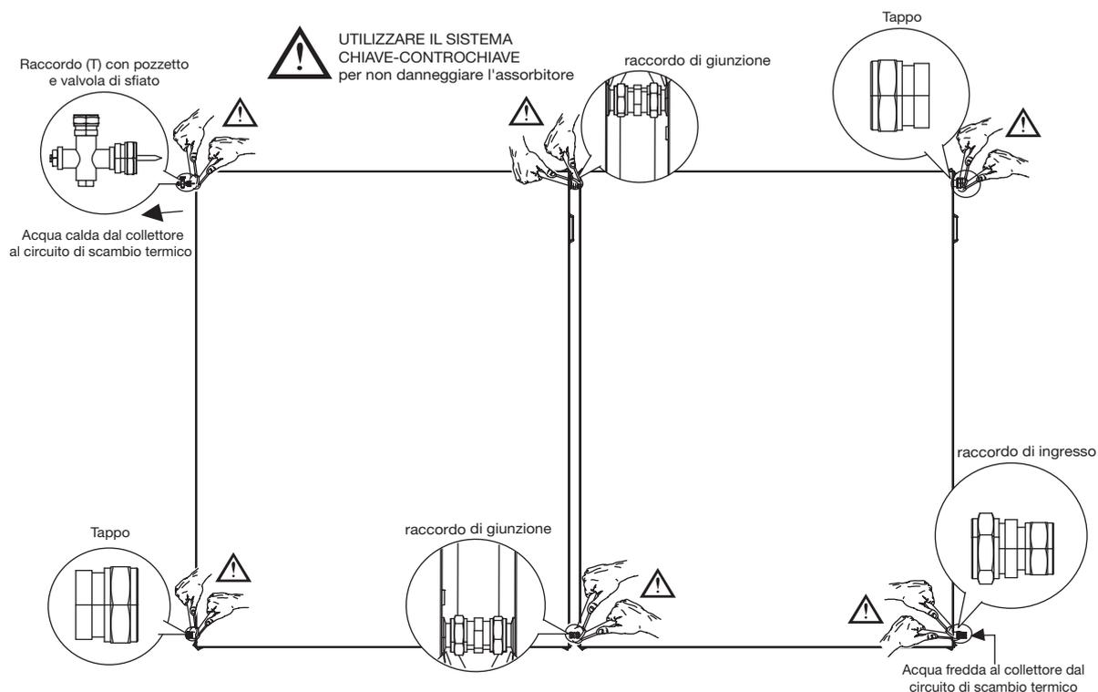
I collettori vengono collegati tra loro in modo che il fluido termovettore li attraversi in parallelo. Il collegamento con il bollitore solare deve essere realizzato in corrispondenza del pozzetto della sonda (T), sull'ultimo collettore della serie (vedere figura). Il posizionamento del pozzetto sul collettore permette il massimo trasferimento del calore accumulato nei pannelli.
