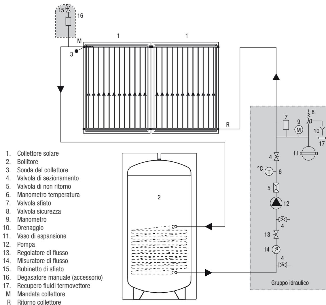
Si consiglia di utilizzare tubazioni in acciaio INOX predisposte per il solare (mandata, ritorno e tubo per la sonda).
