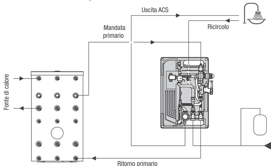
Il modulo deve essere posizionato in prossimità dell'accumulo. Il sistema è dimensionato per una lunghezza delle tubazioni di collegamento tra modulo e bollitore pari a 4 metri (andata + ritorno).
