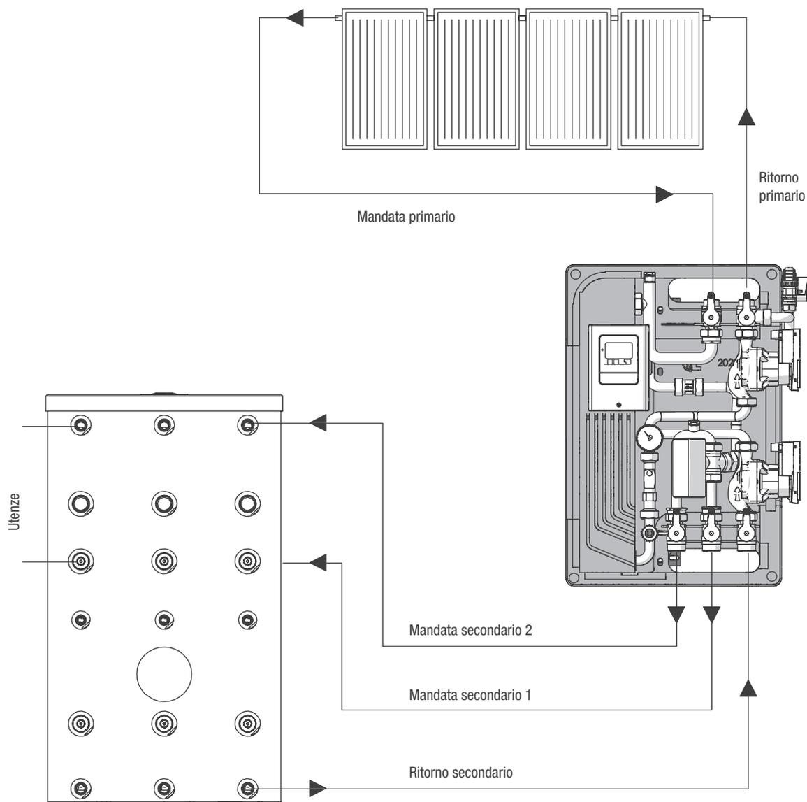
Il modulo deve essere posizionato in prossimità dell'accumulo. Il sistema è dimensionato per una lunghezza delle tubazioni di collegamento tra modulo e bollitore pari a 4 metri (andata + ritorno).
