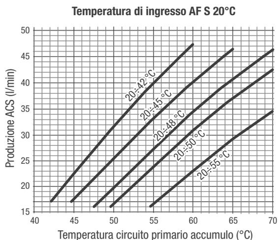
Il corretto funzionamento del modulo è garantito se la temperatura di mandata del circuito primario supera di almeno 5K la temperatura di set ACS impostata.
