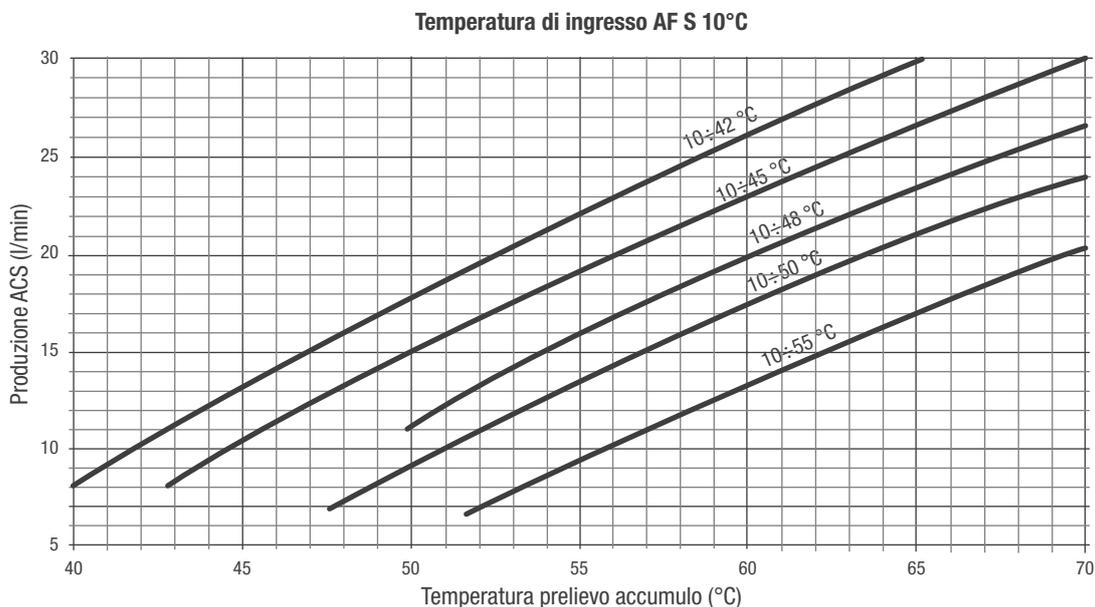
Il corretto funzionamento del modulo è garantito se la temperatura di mandata del circuito primario supera di almeno 5K la temperatura di set ACS impostata.
