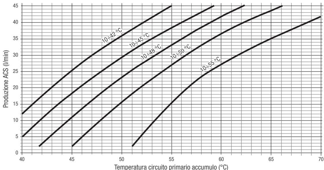
Il corretto funzionamento del modulo è garantito se la temperatura di mandata del circuito primario supera di almeno 5K la temperatura di set ACS impostata.
