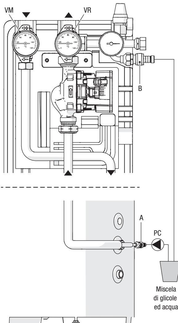
Non eseguire il riempimento dell'impianto in condizioni di forte insolazione e con i collettori ad elevate temperature.
