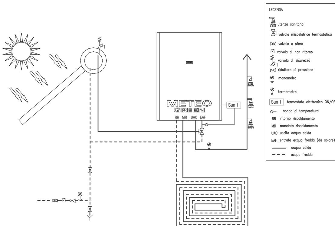
Nello schema sopra riportato è rappresentato un impianto di produzione ACS con caldaia combinata Meteo Green in cascata al bollitore con impianto solare a circolazione naturale.
