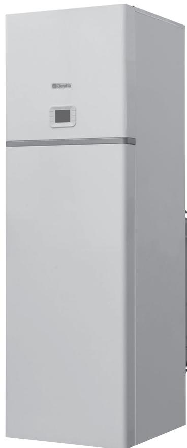
La caldaia a condensazione Tower Green si configura come apparecchio produttore di acqua calda, ad elevata efficienza termica, a bassa temperatura, per impianti di riscaldamento e per uso sanitario, tramite bollitore solare a doppio serpentino della capacità di 200 litri, predisposto di serie con gruppo idraulico di ritorno per l'abbinamento ai pannelli solari termici.
