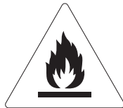
Riesgo de incendio/ materiales inflamables
