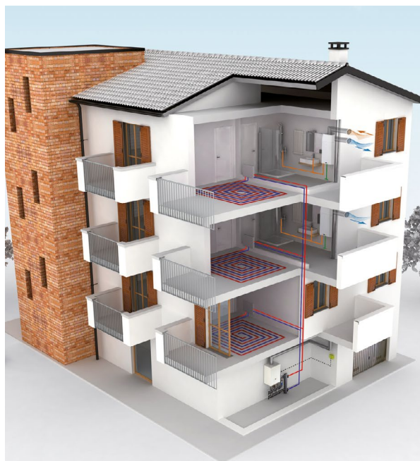
Acquazenit: installazione in condominio
