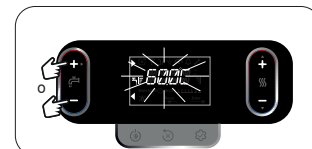
seconda pressione impostazione valore del setpoint sanitario, con step di 0.5°C
