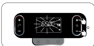
seconda pressione impostazione valore del setpoint riscaldamento, con step di 0.5°C
