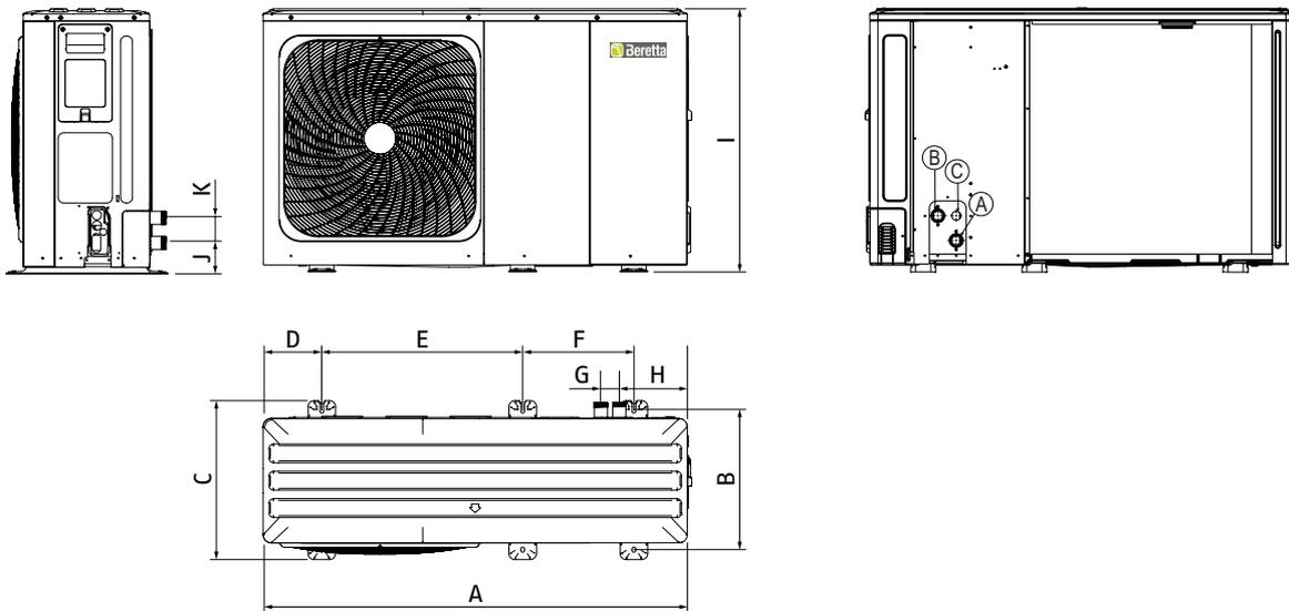
A. Collegamento ingresso acqua    B. Collegamento uscita acqua    C. Attacco di scarico
