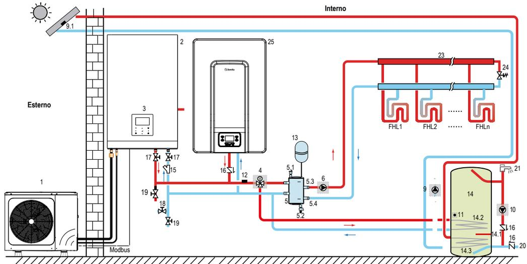
Esempio di installazione per riscaldamento con impianto a pavimento e raffreddamento attraverso ventilconvettori
