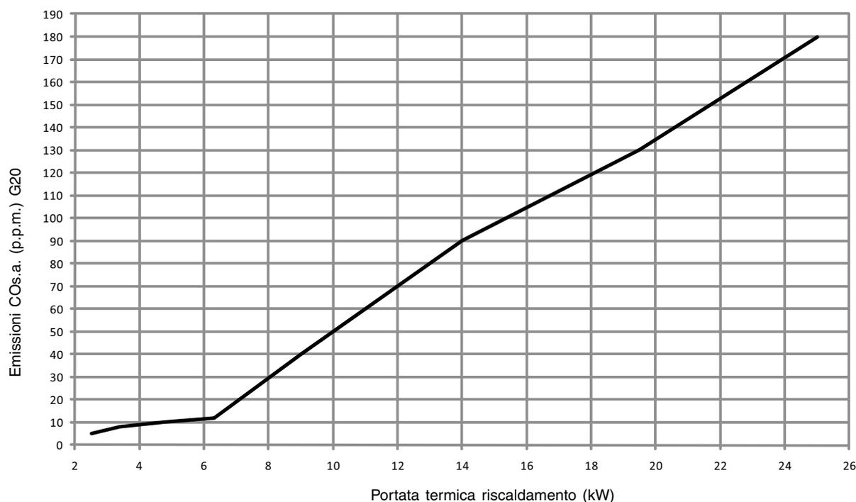
**POSSIBILITÀ REGOLAZIONE DEL MASSIMO RISCALDAMENTO (P. 23) - RANGE RATED**
