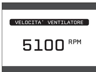
**Nota:** è possibile, in alternativa, modificare la velocità del ventilatore agendo sul trimmer P3 presente sulla scheda elettronica AKL06N (per fare questo è necessario aprire il coperchio del cruscotto per accedere alla componentistica elettronica).
