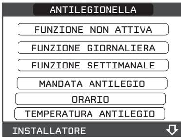
Il tempo di mantenimento del bollitore per antilegionella varia in funzione della temperatura impostata nel parametro TEMPERATURA ANTILEGIO, come indicato in tabella:
