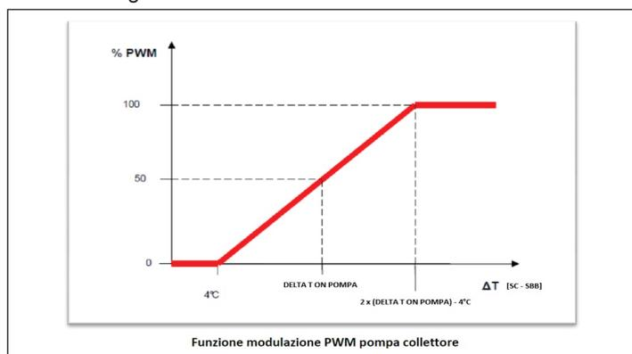
Tale modulazione PWM agisce in percentuale sul periodo di ON della pompa collettore CS rispetto ad un periodo di tempo che è dato dal valore del parametro [PWM POMPA COLLETTORE]. Se il parametro [PWM POMPA COLLETTORE] = 0 allora la modulazione viene disattivata e la pompa collettore rimane costantemente attiva qualora sia presente la richiesta.
