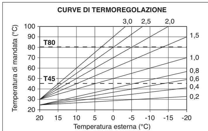
**T80** massima temperatura setpoint riscaldamento impianti standard
