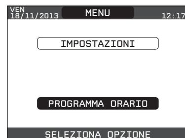
Da questo menù è possibile accedere alla visualizzazione e regolazione della programmazione oraria per le funzioni riscaldamento di una zona piuttosto che per il carico del bollitore sanitario da caldaia.
