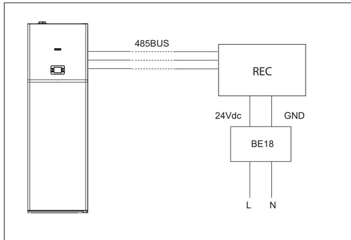
**NOTA** - È raccomandabile che l'alimentatore BE18 venga installato in prossimità del REC10 da alimentare, il collegamento del REC10 con la caldaia è a 3 fili!
