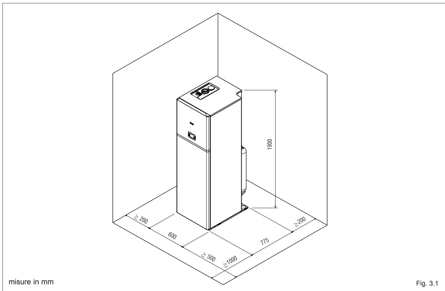
⚠ Tenere in considerazione gli spazi necessari per l'accessibilità ai dispositivi di sicurezza e regolazione e per l'effettuazione delle operazioni di manutenzione.
