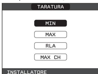
**!** La taratura non comporta l'accensione della caldaia.
