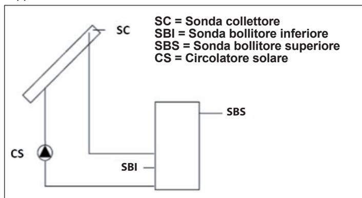
⚠ Per l'attivazione del circuito solare è necessario impostare opportunamente il parametro "STATO POMPA SOLARE".
