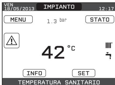
Trascorso il tempo transitorio, se l'anomalia persiste, viene visualizzato il codice di anomalia E040. Con caldaia in anomalia E040 è necessario procedere al caricamento manuale agendo sul rubinetto di riempimento sino a che la pressione raggiunge un valore compreso tra 1 e 1,5 bar.
