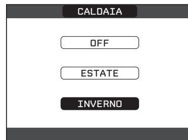
**!** Tutte le volte che la caldaia viene alimentata viene eseguito un ciclo di sfiato automatico della durata di 15 min. Quando il ciclo di sfiato è in corso tutte le richieste di calore sono inibite e un messaggio scorrevole a piè di pagina compare nella schermata principale del REC10. Il ciclo di sfiato può essere preventivamente interrotto aprendo il cruscotto e premendo il pulsante analisi combustione SW1 oppure da menù TECNICO del REC10 nel seguente modo:
