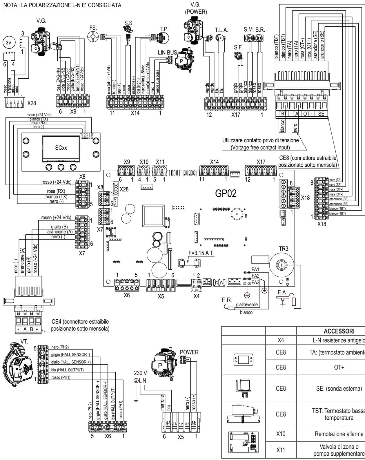
**Schema elettrico multifilare**
