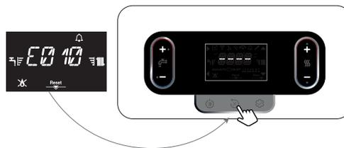
A questo punto la caldaia, se le condizioni di corretto funzionamento sono ripristinate, riparte automaticamente. Sono possibili fino ad un massimo di 5 tentativi di sblocco consecutivi dello stesso allarme dall'interfaccia, terminati i quali sul display viene visualizzato il codice di errore E099.
