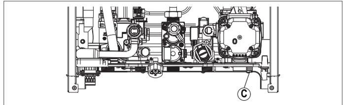
NOTA: le operazioni di **riempimento** dell'impianto devono essere fatte agendo sul rubinetto di riempimento (**esterno alla caldaia**) assicurandosi che la caldaia sia alimentata elettricamente.
