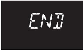
Al termine della funzione il parametro torna automaticamente a 0.
