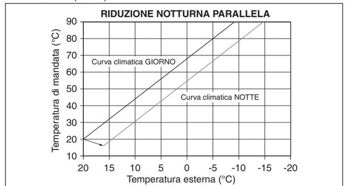
L'utente può indirettamente intervenire sul valore di setpoint RISCALDAMENTO andando ancora una volta ad introdurre, sul valore di temperatura di riferimento GIORNO (20°C) piuttosto che NOTTE (16°C), un offset che può variare all'interno del range [-5 ÷ +5]. La COMPENSAZIONE NOTTURNA non è disponibile se collegato crono OT+. Per la correzione dell'offset fare riferimento al paragrafo "8.3 Impostazione setpoint riscaldamento".
