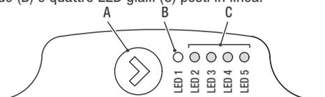
L'interfaccia utente permette di visualizzare le prestazioni in funzionamento (stato funzionamento e stato allarme) e impostare le modalità di funzionamento del circolatore.
