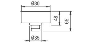
Kit chiusura raccordo a "T" per scarico condensa
