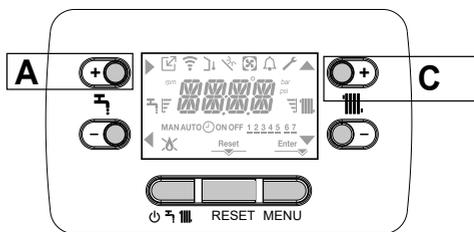
Tutte le volte che la caldaia è alimentata viene eseguito un ciclo di sfiato della durata di 4 min. Il display visualizza -AIR e si accende l'icona RESET.
